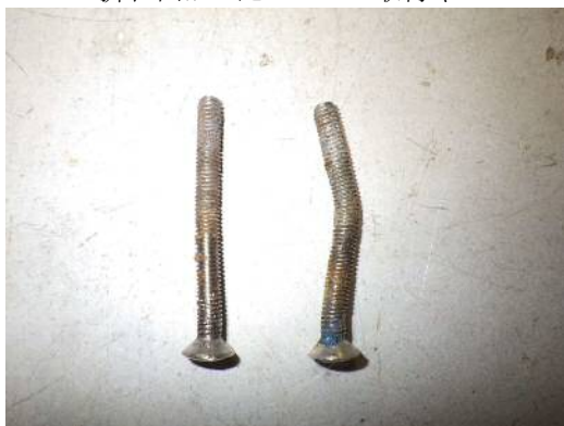
折れ曲がったバンパー取付ネジ
