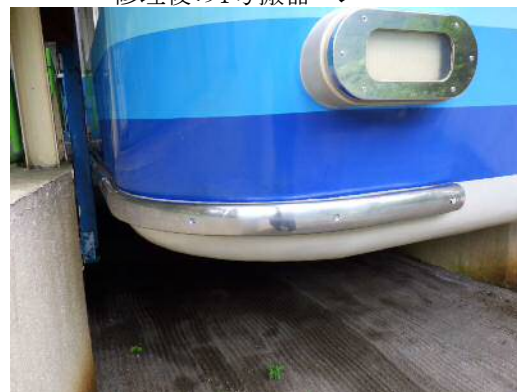
修理後の1号搬器バンパー
